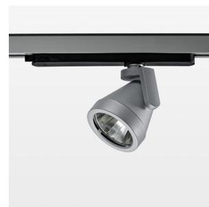
Aufbauleuchte mit LED, Bemessungslebensdauer der LED L80/B10 > 50000 h, Farbwiedergabeindex CRI > 80, Farborttoleranz 2 SDCM (initial), Reflektor mit kreisförmigem Lichtbild, Reflektor Reinstaluminium 99,99% in MIRO-Silver®, Drehwinkel 330°, Schwenkwinkel +85°/-85°, Leuchtenkopf/Haltearm Aluminium-Druckguss, pulverbeschichtet, Stratosilber
